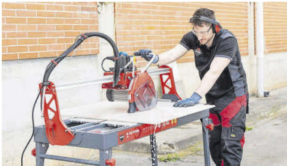
Su sistema de refrigeración C3 System Python permite ajustar el punto de aplicación del agua.
