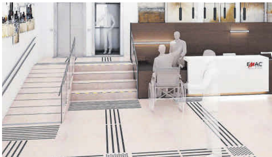
Las bandas y botones podotáctiles que comercializa Emac son elementos de pavimentación con texturas específicas que pueden ser detectadas a través del tacto con los pies o un bastón.
