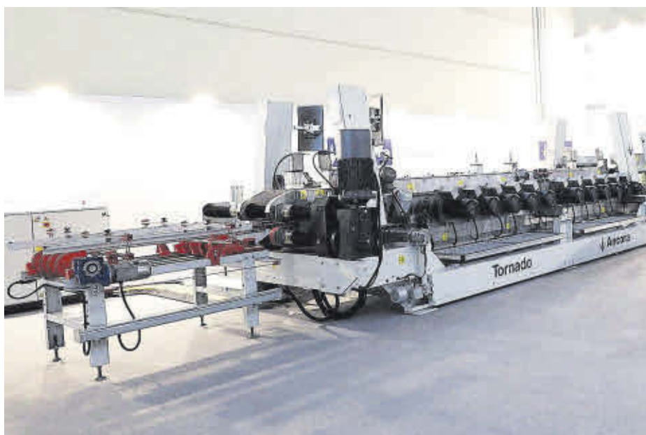
'Tornado', la nueva rectificadora en seco para grandes producciones cerámicas 100% automatizada.
