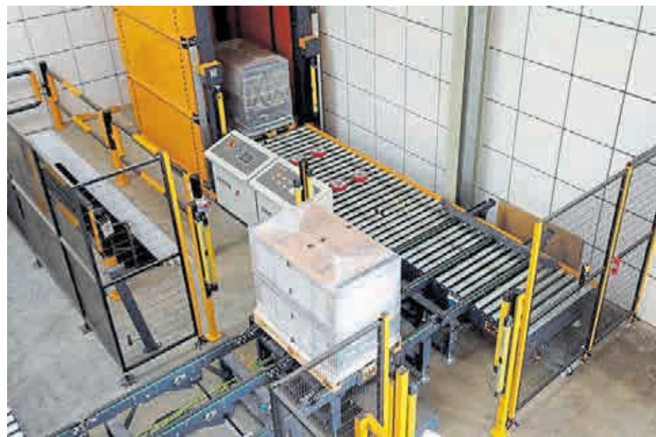
Vista general de la nueva línea de transporte, verificación y clasificación de palets desarrollada por Innova e instalada en el centro logístico principal de Porcelanosa en Vila-real para mejorar los flujos.
