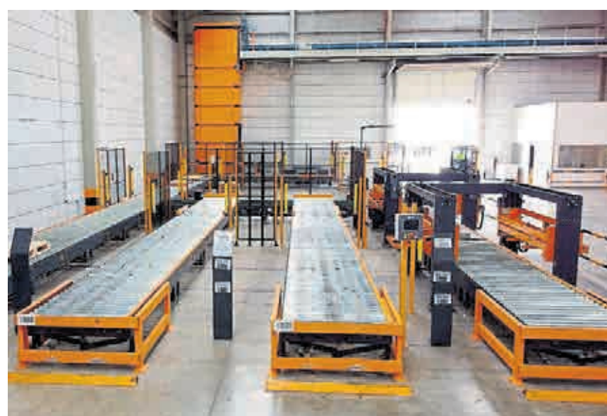
La instalación incorpora dos entradas para el material de producción y una línea específica de control de palets vacíos, garantizando su verificación antes de acceder al almacén inteligente de Porcelanosa.
