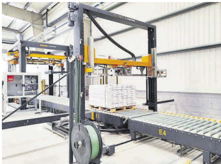
El sistema de flejado vertical automático une la carga con la base del palet en la nueva línea.
