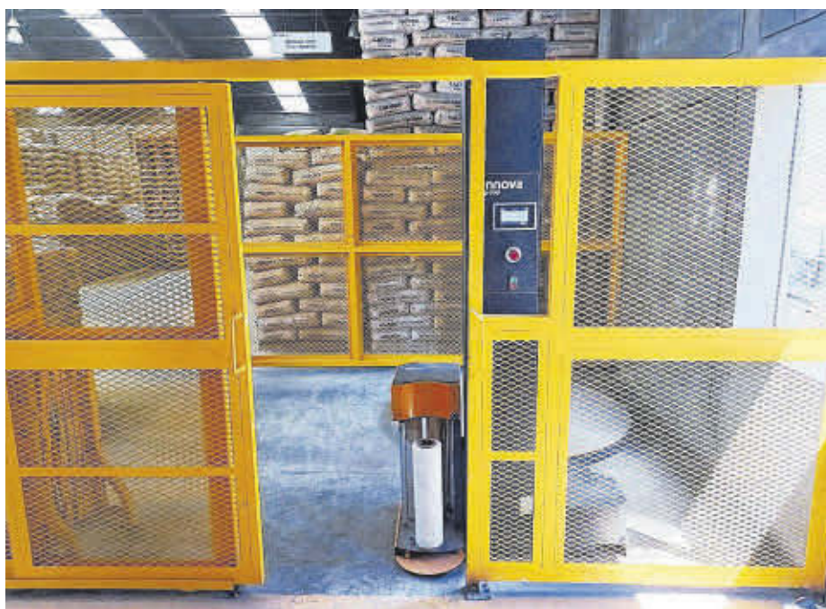
Todos los sistemas de enfardado del proyecto cuentan con sistemas de preestiro motorizado.
