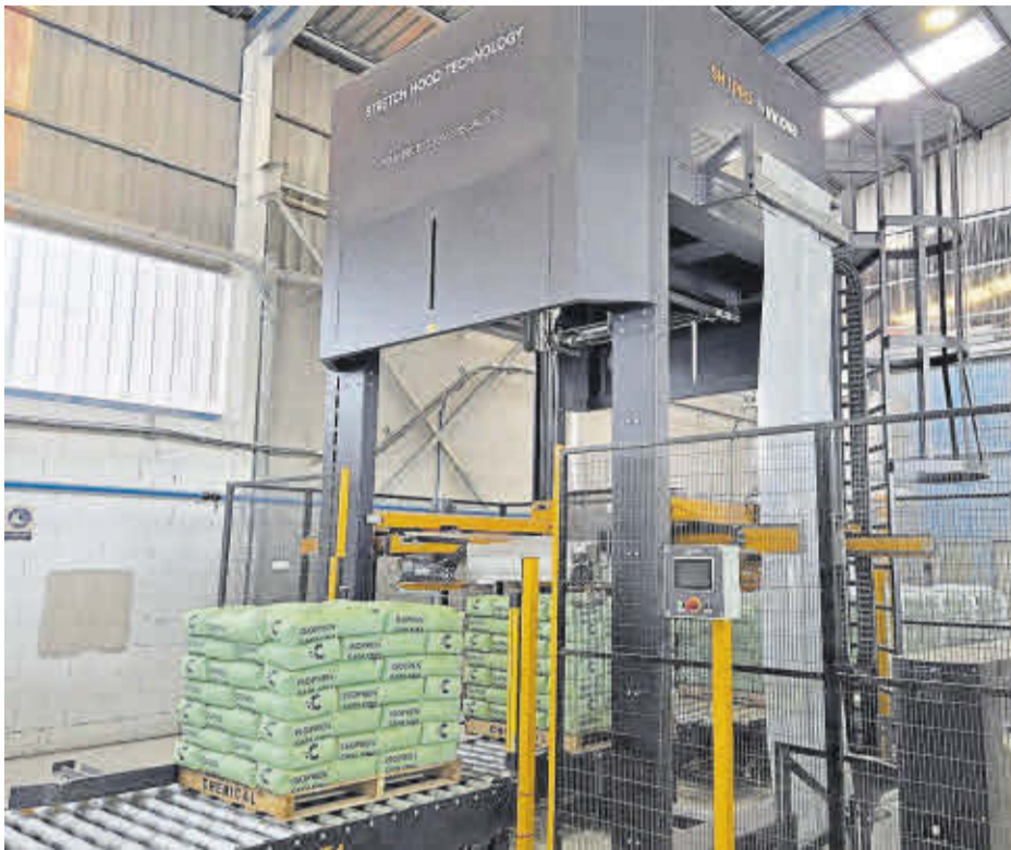
El proyecto ha consistido en la instalación de una línea de embalaje 'Stretch Hood' en su nueva planta en Macael, integrándola en el flujo logístico de la fábrica y conectándola con la estación de paletizado.
