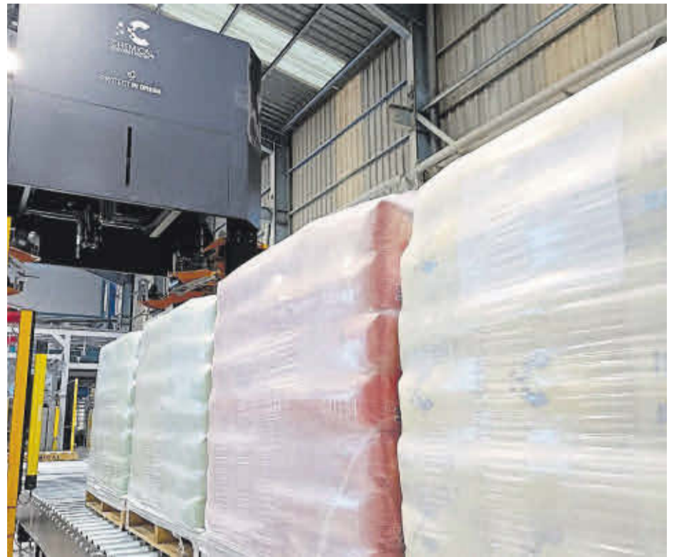
El proyecto ha consistido en la instalación de una línea de embalaje 'Stretch Hood' en su nueva planta en Macael, integrándola en el flujo logístico de la fábrica y conectándola con la estación de paletizado.
