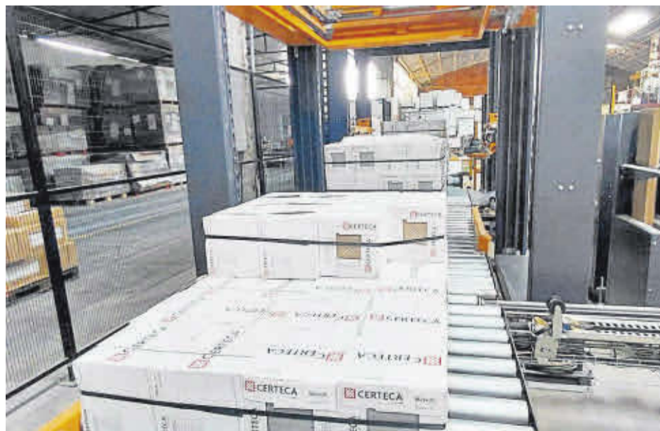
El proyecto ha consistido en sustituir su anterior sistema de embalaje semiautomático por una nueva línea automática compuesta por los sistemas de flejado horizontal y 'Stretch Hood' de Innova Group.
