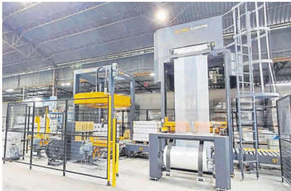
El proyecto ha consistido en sustituir su anterior sistema de embalaje semiautomático por una nueva línea automática compuesta por los sistemas de flejado horizontal y 'Stretch Hood' de Innova Group.
