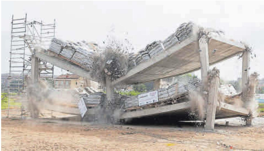
El edificio experimental construido por el grupo Building Resilient en las instalaciones de la Universitat Politècnica de València permitió comprobar la eficacia del nuevo sistema de refuerzo.
